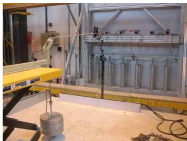
Essai statique horizontal vers l'intérieur sur vitrage 88.4 fixé à plat avec pré charge de 20 daN et chargement à 40 daN sur garde-corps fixé à plat.
