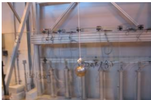
Chocs de sécurité avec bille acier D0,5 et de conservation des performances avec bille D1(1,00 kg)
