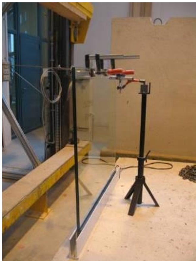
Essai statique horizontal vers l'extérieur sur vitrage 88.4 avec charge d'exploitation et trois fois sa charge en sécurité pendant 15 minutes pour le public.
