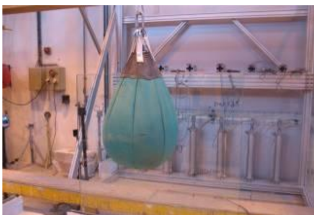
Choc de sécurité avec sac sphéroconique M50/900J et choc mou M50/700J
