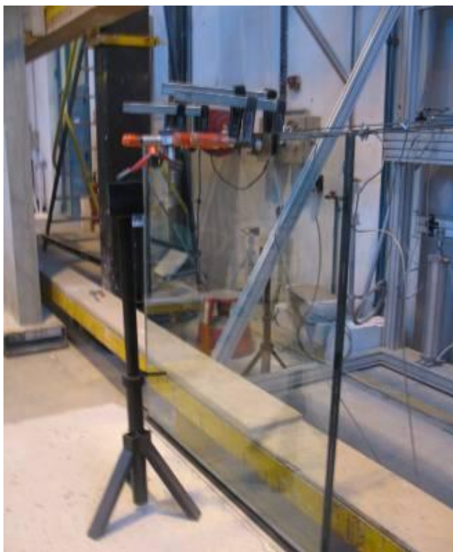
Essai statique avec charge d'exploitation et charge de sécurité sur vitrage 1212.4 pour le stade
