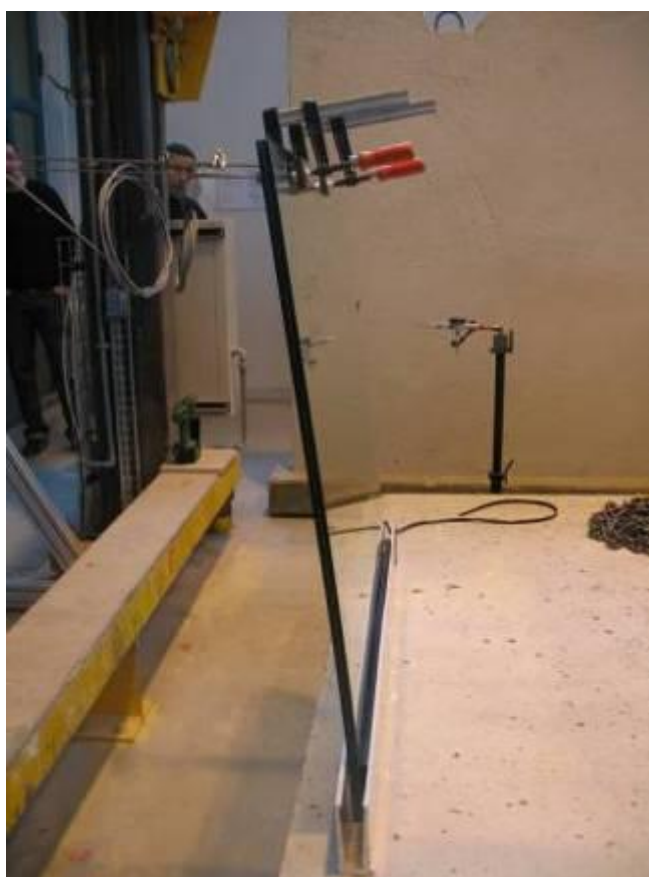
Essai statique horizontal vers l'extérieur sur vitrage 88.4 avec charge d'exploitation et trois fois sa charge en sécurité pendant 15 minutes pour le public.
