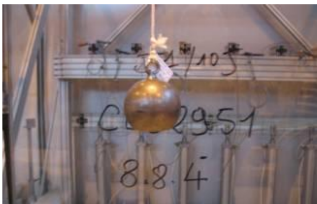
Chocs de sécurité avec bille acier D0,5 et de conservation des performances avec bille D1(1,00 kg)
