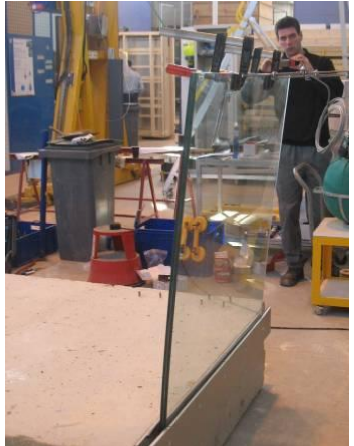
Essai statique avec charge d'exploitation et charge de sécurité sur vitrage 1010.2 pour le public
