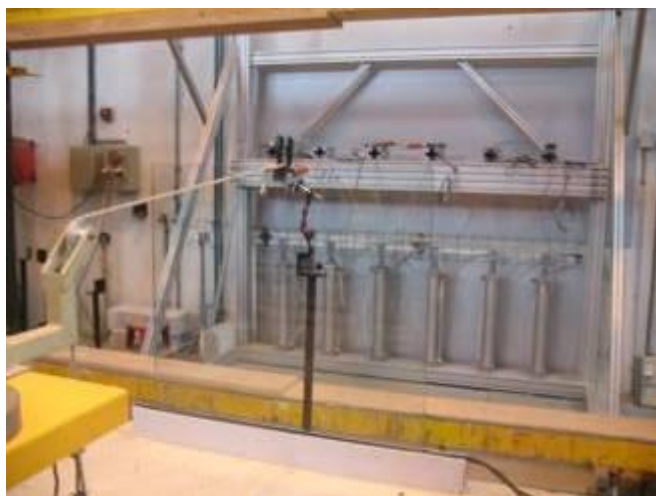
Essai statique horizontal vers l'intérieur sur vitrage 88.4 fixé à plat avec pré charge de 20 daN et chargement à 40 daN sur garde-corps fixé à plat.
