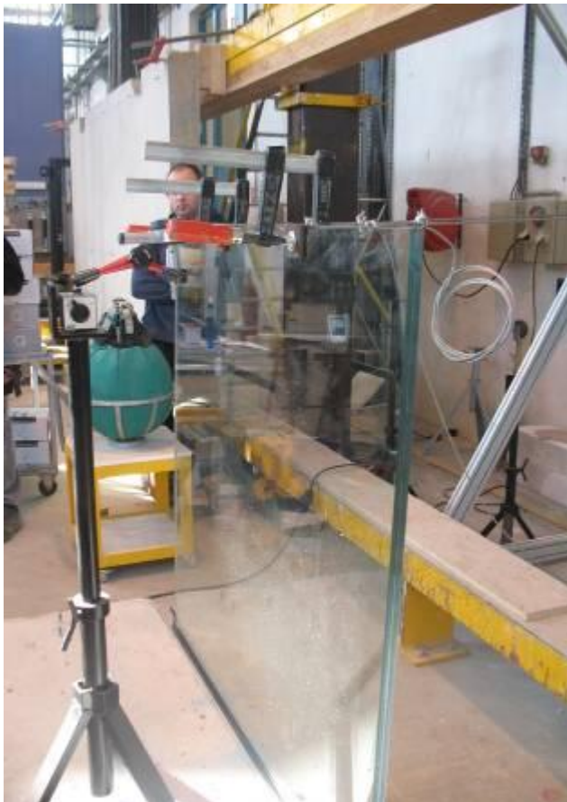
Essai statique avec charge d'exploitation et charge de sécurité sur vitrage 1010.2 pour le public
