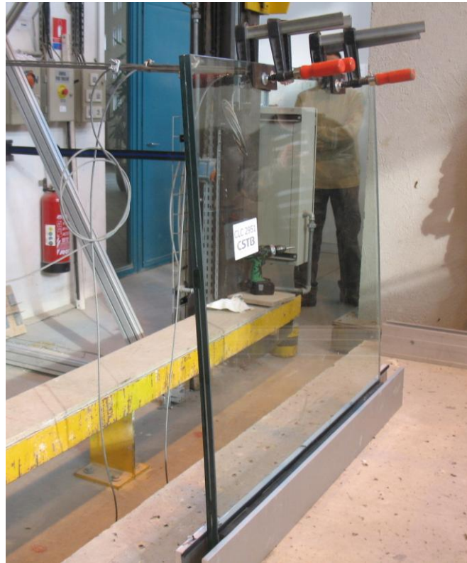
Essai statique avec charge d'exploitation pour stade sur vitrage 1212.4 et charge de sécurité
