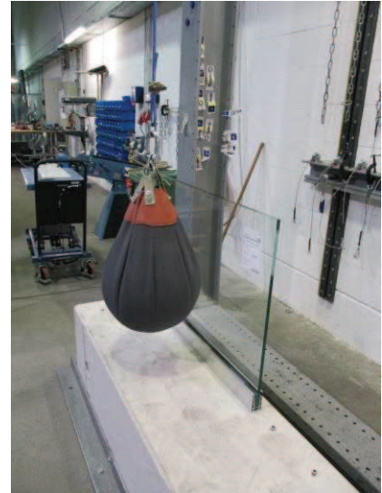
Impact test 6.6.2/h=700mm.
